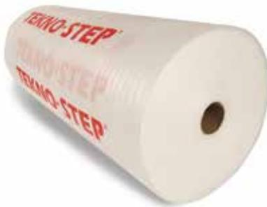
Es un bajo suelo de polietileno de baja densidad laminado por una cara con una película de polietileno que sirve para constituir una barrera de humedad entre el firme y el piso laminado o piso de madera de ingeniería que se instalan flotados sobre el mismo. Se disponen en espesores de 1/16" y 3/32". El uso de un bajo suelo laminado es obligatorio en un piso flotado.
